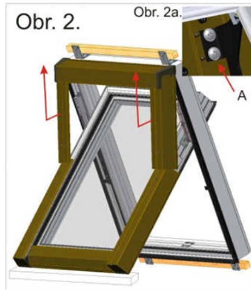
Obr. 2. Demontáž křídla: před zahájením demontáže položte okno viz Obr. 2. Pod dolní hranu křídla vložte měkký materiál například (rmolitan, polystyren apod.), aby nedošlo k poškození výrobku. Odšroubujte šrouby A pod oplechováním a lehce vysuňte oplechování viz šipky na obrázku.
