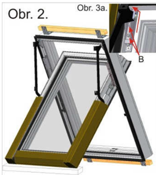
Obr. 2. Po odstranění horní části oplechování povolit zajišťovací šrouby B a rozpojit kování jak je nakresleno na Obr.3a. Toto provést současně na levé i pravé straně. Vyjměte opatrně křídlo a položte ho na čistou a měkkou podložku. Odšroubujte horní a dolní
