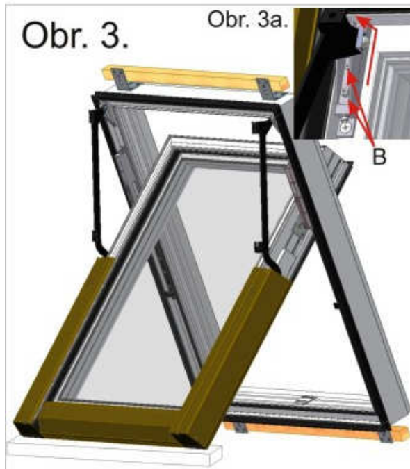
Obr. 3. Po odstranění horní části oplechování povolte zajišťovací šrouby B a rozpojte kování jak je nakresleno na Obr. 3a. Toto provést současně na levé i pravé straně. Vyjměte opatrně křídlo a položte ho na čistou a měkkou podložku. Odšroubujte horní a dolní dřevěnou transportní lištu.
