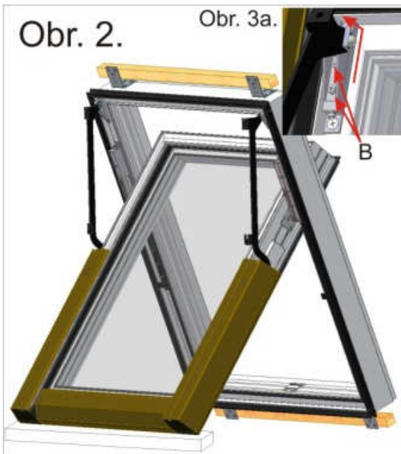
Obr. 2. Po odstranění horní části oplechování povolit zajišťovací šrouby B a rozpojit kování jak je nakresleno na Obr.3a. Toto provést současně na levé i pravé straně. Vyjměte opatrně křídlo a položte ho na čistou a měkkou podložku. Odšroubujte horní a dolní dřevěnou transportní lištu.
