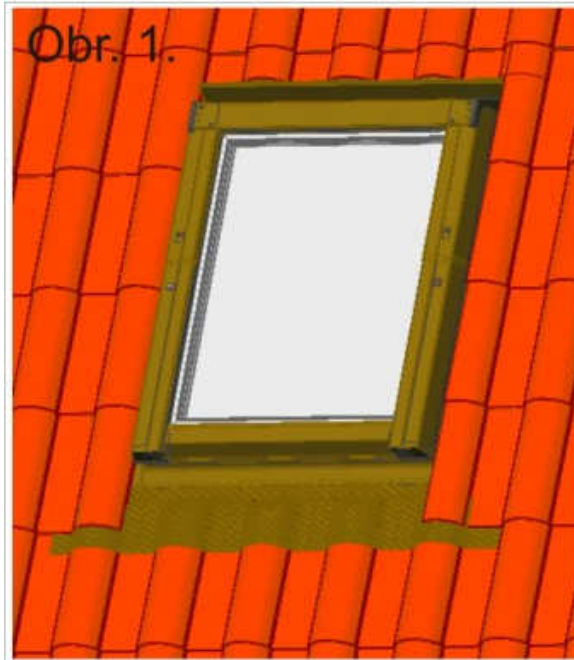
Obr. 1. Střešní okno Skylight Premium zamontované ve střeše s vlnitou střešní křtinou.
